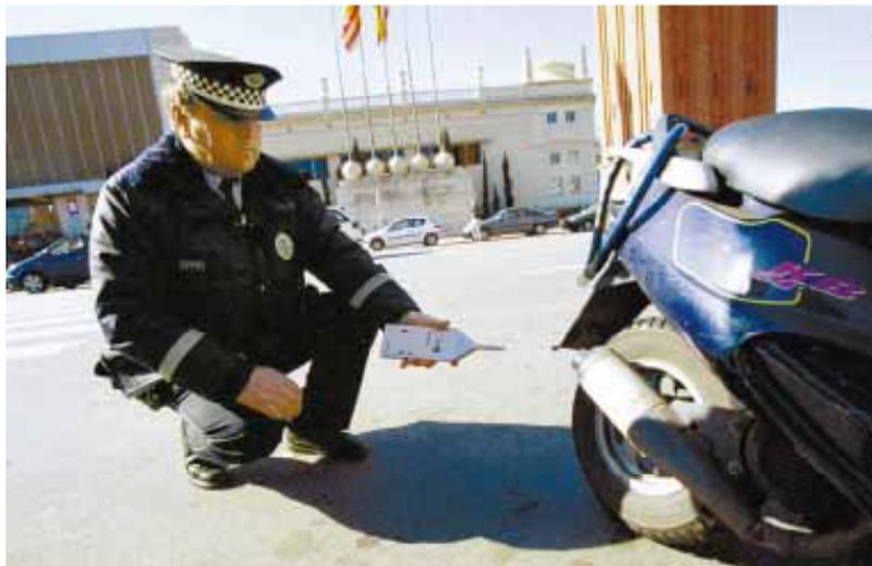
Medida incorrecta del ruid de una motocicleta. El sonómetro está pegado al tubo de escape, no lleva protector, y está alineado con respecto de la salida de gases.
